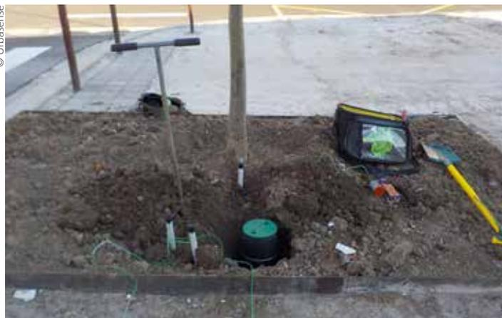
**Par l'intermédiaire de sondes tensiométriques, la mesure directe des forces de succion de l'eau dans le sol s'avère la méthode la plus pertinente pour analyser avec précision les besoins en eau de l'arbre dès sa plantation. Et un arbre bien arrosé est un arbre bien enraciné ; et un arbre bien enraciné prospecte l'eau en profondeur et résiste aux aléas climatiques !**
